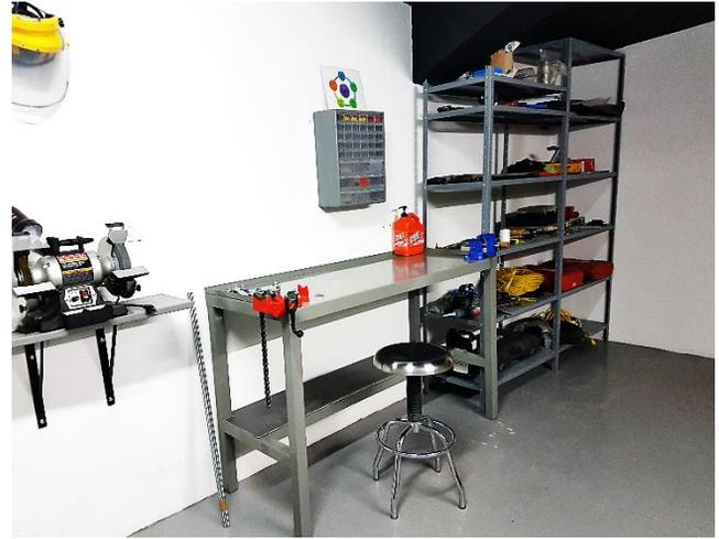
Mesas de trabajo de fabricación específica con elementos para diversas necesidades de uso ya sea con cubiertas de metal, madera o laminado plástico, además de iluminación, contactos eléctricos, colgadores de herramientas etc.
